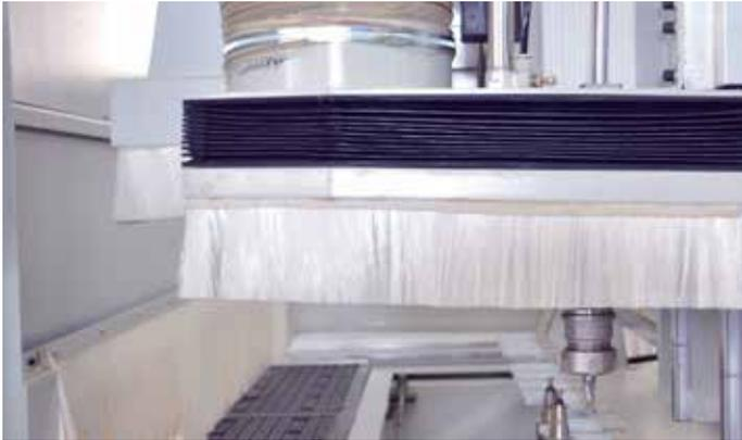
**Cabezal de fresado**
