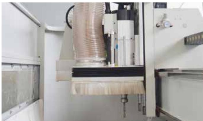
**Cabezal de fresado**
