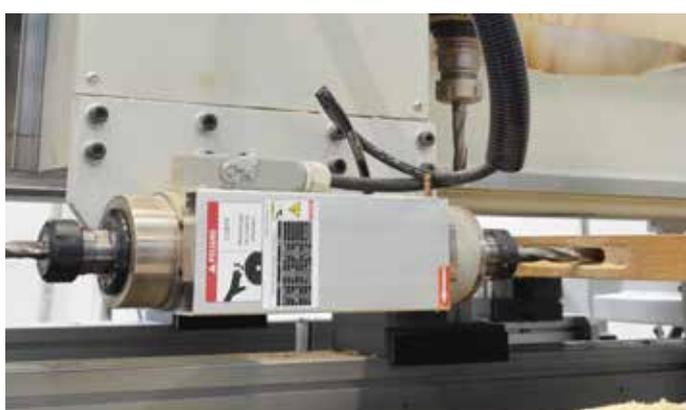
**Motor horizontal doble salida
