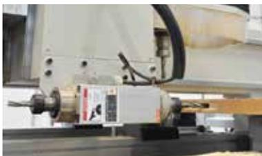
*Motor horizontal de doble salida*
