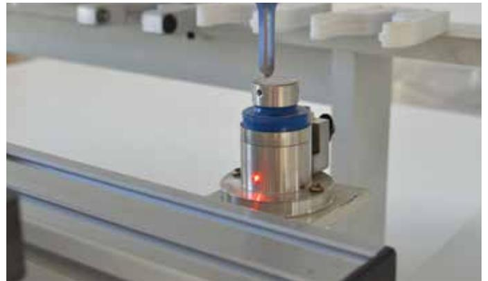
**Sensor de calibrado de herramienta**
