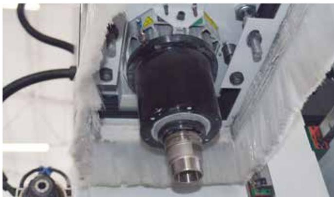
**Cabezal de fresado**
