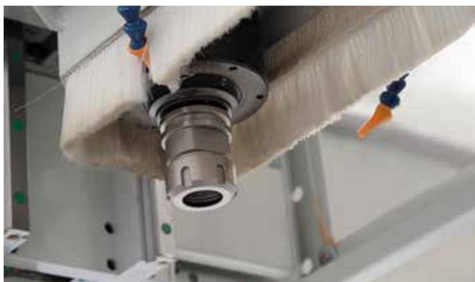
**Cabezal de fresado**
