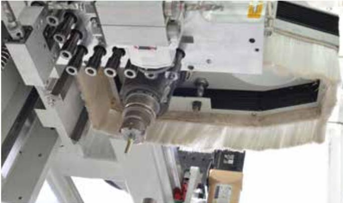
**Cabezal de fresado**
