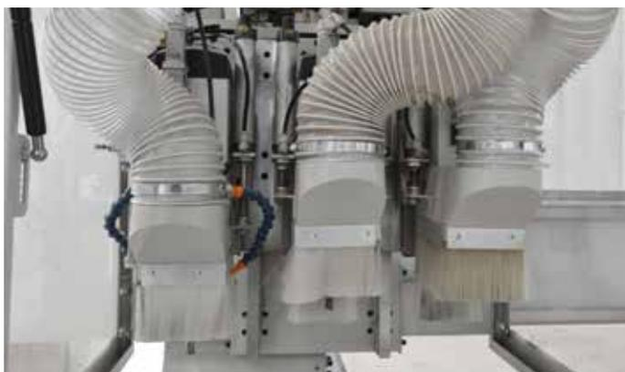
**Cabezal de fresado**
