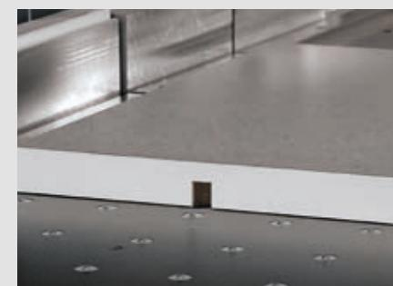
**IT** A richiesta, **l'altezza lama sega programmabile** permette il controllo automatico della sporgenza della lama principale con sistema di lettura ad alta risoluzione, per assicurare sempre la miglior qualità di taglio. Sistema per **l'esecuzione di finestre e scanalature** la cui larghezza ed altezza può essere programmata tramite il controllo. I diversi schemi possono essere memorizzati sul controllo.
