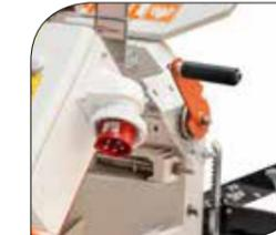
Acceso fácil y rápido del aserrador a: manivela de movimiento vertical del cabezal, brazo guiasierra y palanca de control de la sierra.
