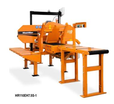
El reaserradero HR110 es nuestra propuesta para aquellos clientes que buscan un equipo eficiente y a buen precio. El reaserradero HR110 está equipado con un motor eléctrico de 5,5 kW.
