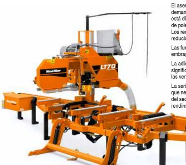
El aserradero de serie LT70 ha sido diseñado para satisfacer las demandas de las plantas procesadoras de troncos modernas. El cabezal está diseñado para ser excepcionalmente duradero y seguro, y dispone de poleas portasierras de 600 mm y guías de bloque dobles para rodillos. Los requisitos de alineación y mantenimiento de aserraderos se han reducido al mínimo.
