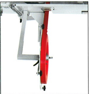
EDGE BAND FEED-IN ALIMENTACIÓN DE CANTO ALIMENTAZIONE BORDO 0,4 - 2,0 mm ROLL ROLLO ROTULO
