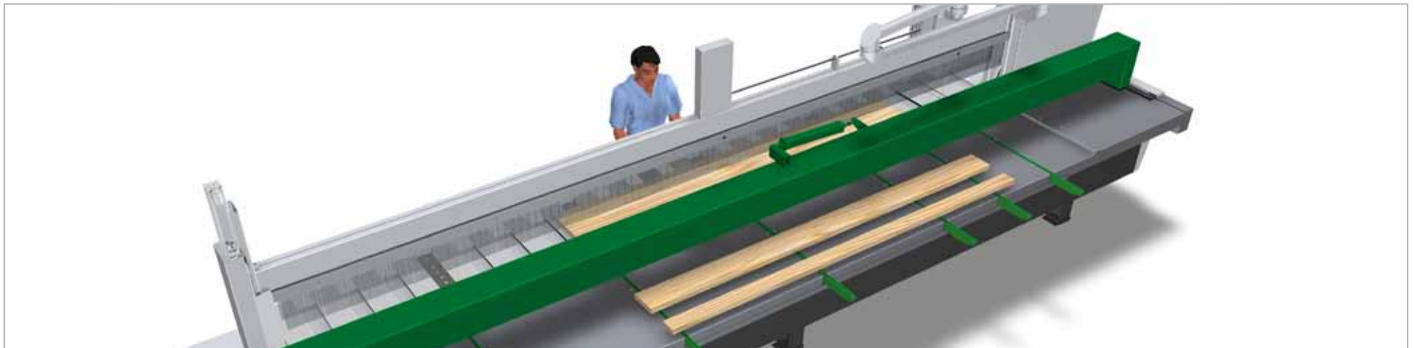
Tope autoportante en forma de puente
