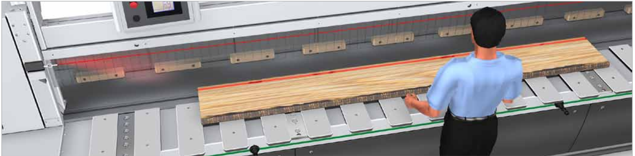
Posicionar la pieza a trabajar en la mesa de máquina
