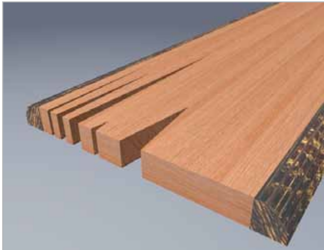
Corte longitudinal / Cantear
