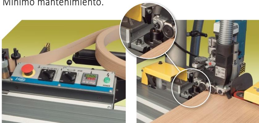
Panel de mandos simplificado. Control electrónico de la temperatura de la cola sin oscilaciones controlada por microprocesador.
