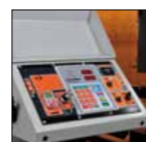
Panel de control con programador automático El programador automático de corte de serie aumenta la productividad y coloca el cabezal con precisión para realizar el siguiente corte.
