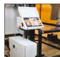
Estación móvil del operario La estación del operario se desplaza con el cabezal para un seguimiento seguro durante el proceso de corte.
