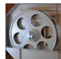
Poleas portasierras Las poleas de acero de 1.070 mm de diámetro reducen la tensión de la sierra y cuentan con un sistema de lubricación de serie.
