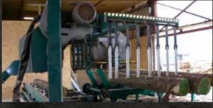
"A pesar de utilizar la misma tecnología de cinta estrecha que los modelos LT15 v LT40, la WM3000 es mucho más rápida. Los troncos se acumulan en un depósito externo, sobre una plataforma que los transfiere a un taller. Una vez allí se cargan en el aserradero mediante el uso de brazos hidráulicos. A diferencia de los modelos LT15 o LT40, la WM3000 se maneja por control remoto desde una rahina cerrada con una vista excelente del proceso
