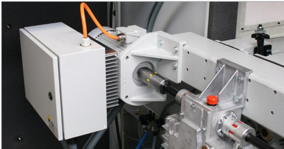
Velocidad de avance regulada mediante regulador de frecuencia, de regulación continua (accionamiento directo)
