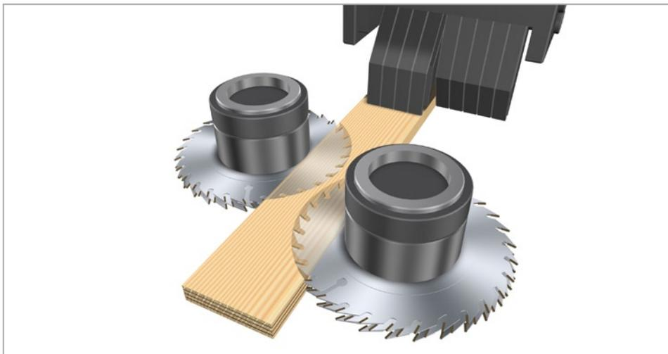
Unidad de corte o aserrado con dispositivo de seguridad contra retroceso
