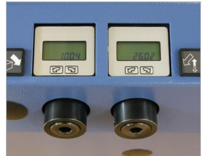
O: ajuste automático mediante ejes CNC (equipo opcional)
