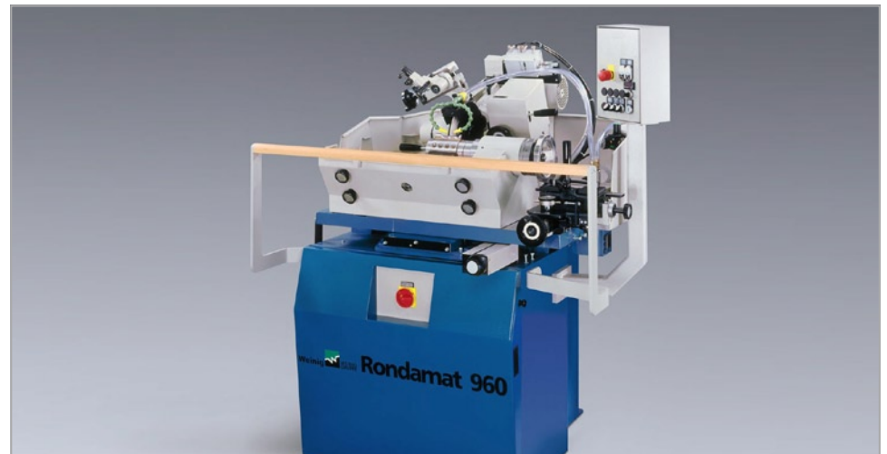
Afilar, reafilar y perfilar con la Rondamat
