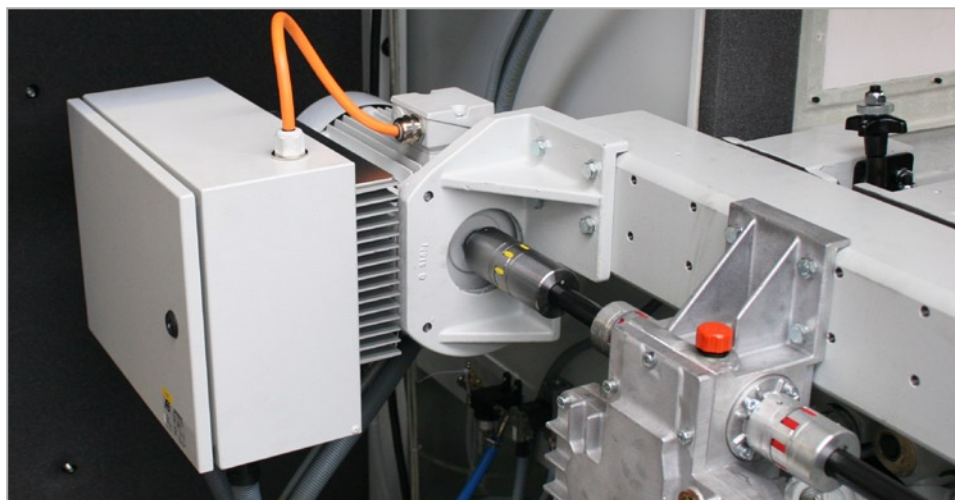
Avance con regulador de frecuencia de regulación continua (accionamiento directo)
