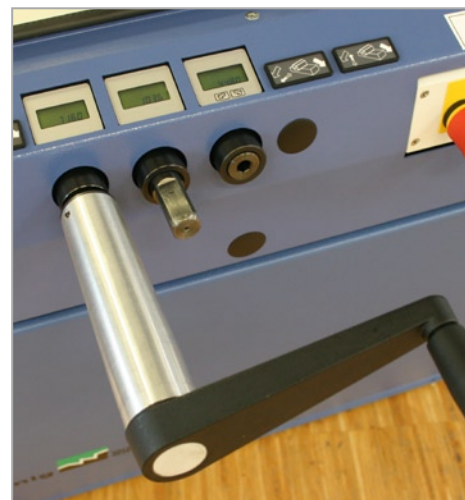
Ajuste mediante la manivela en el sentido de la flecha
