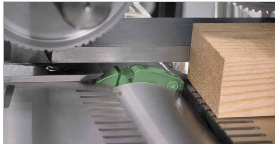
Fresa de precanto en el primer soporte de herramientas horizontal inferior
