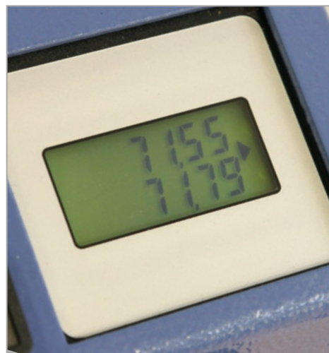
Se visualizan los valores deseados (arriba) y los valores reales (abajo)
