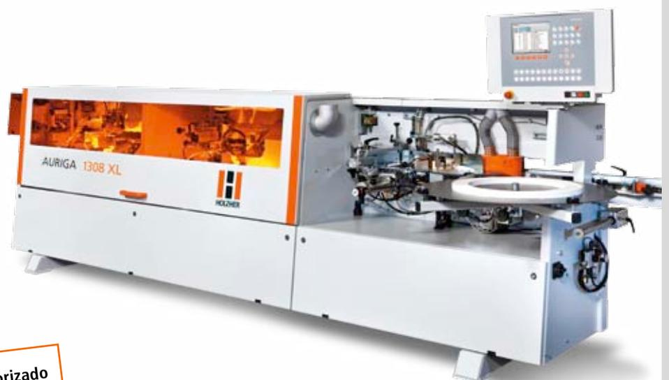
Opcional con ajuste motorizado del puente prensor
