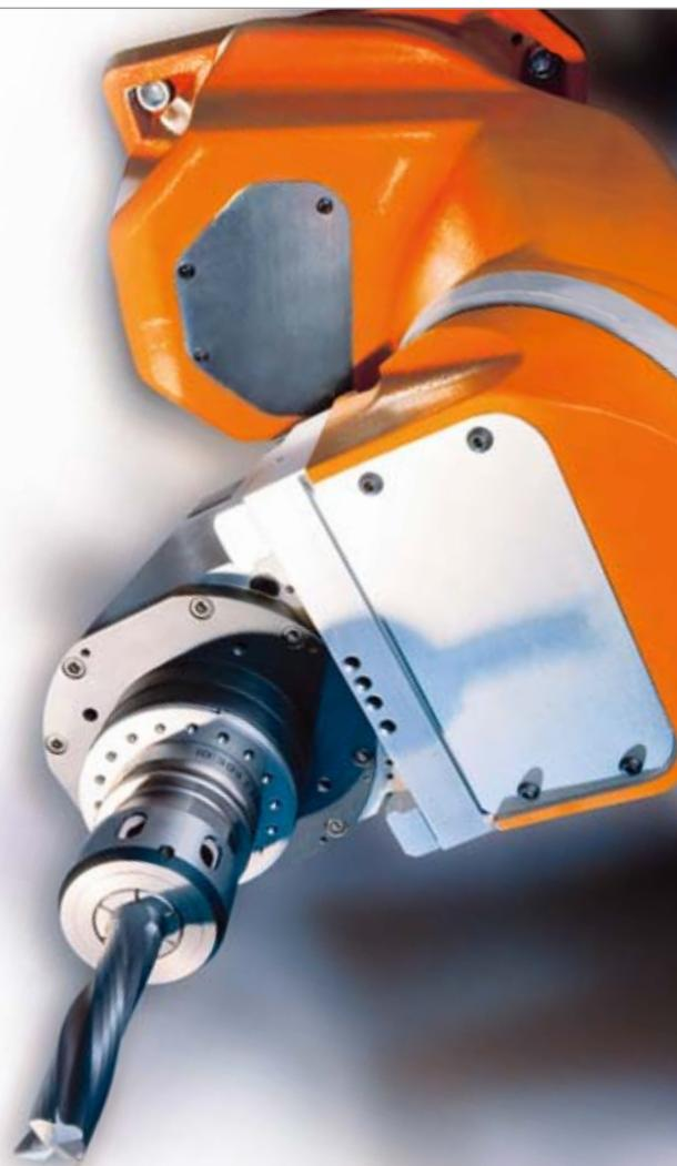
Husillo único PRO-TORQUE de 17 kW para trabajos pesados en madera maciza. Frenos mecánicos en cada posición para ejes A y C, para conseguir la máxima rigidez y resultados perfectos con trabajos que presenten una gran carga.
