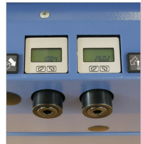
O: ajuste automático mediante ejes CNC (equipo opcional)
