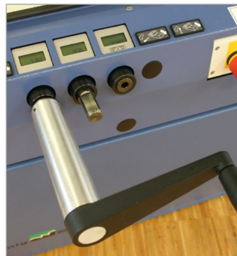
Ajuste mediante la manivela en el sentido de la flecha
