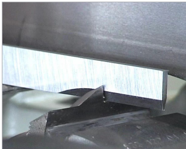
Producir un perfil nuevo: primer ajuste con ayuda de la regla o una pieza de prueba
