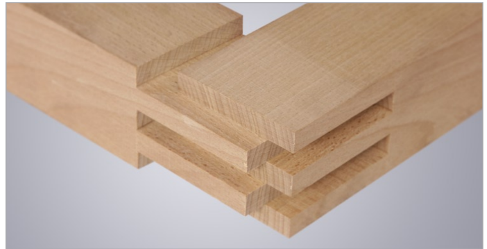
Ensamblaje angular mediante macho y hembra doble
