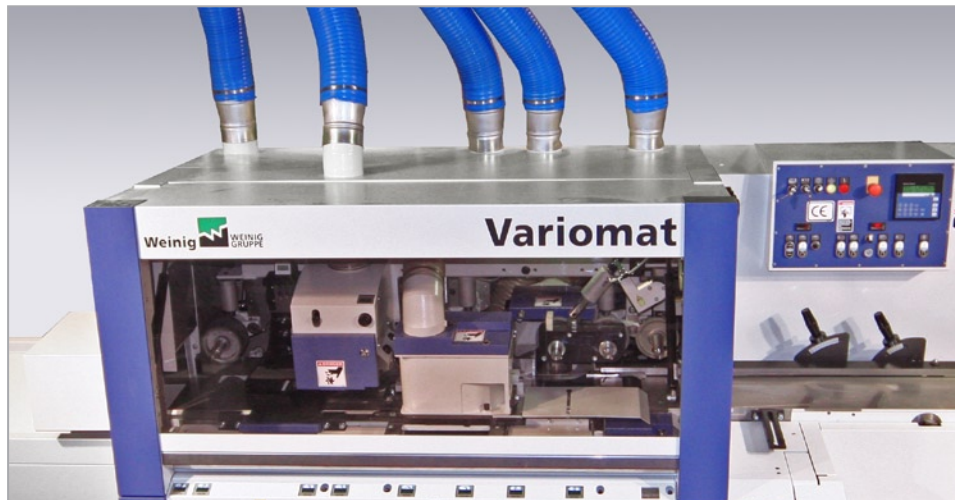
Aspiración: consumo total de aire por cada husillo: 19-22 m 3 / min Velocidad de aire 30 – 34 m/s
