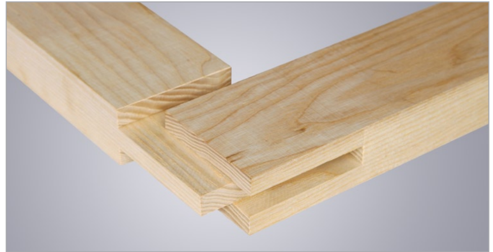
Ensamblaje angular mediante macho y hembra simple
